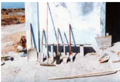
Alfaias utilizadas no governo da marinhas: pá balde, pá de moirar, ancinho, pá de valar, pá-cova, pá de bater e punhos (Fotografia: Câmara Municipal de Alcochete)
